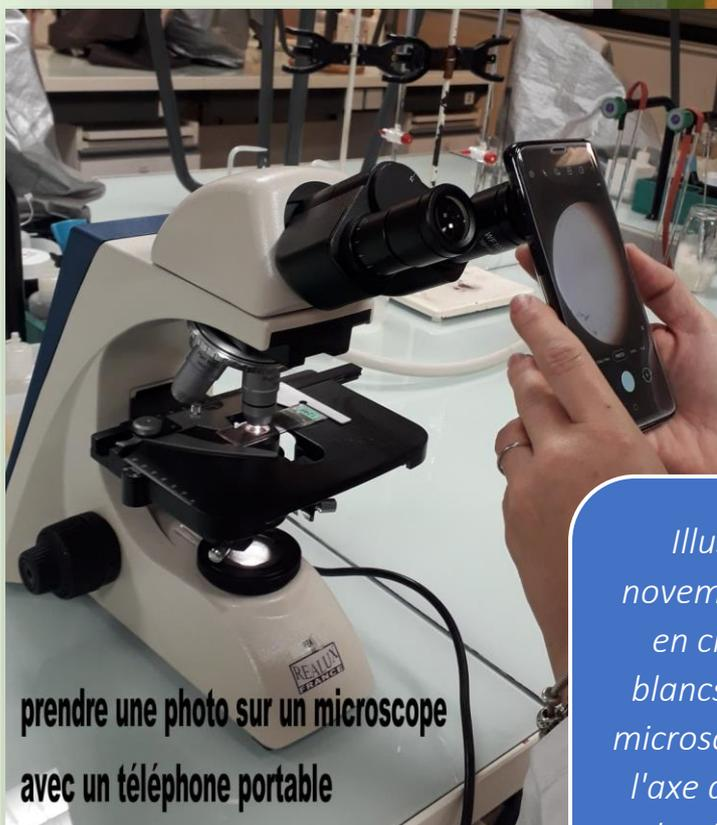
**prendre une photo sur un microscope avec un téléphone portable**
